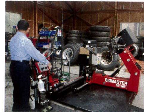
社屋(上)は1階が東京湾岸支店、2階が本社となっている。下は手を触れずにトラックのタイヤを交換できる最新鋭マシン(オートチェンジャー)。
